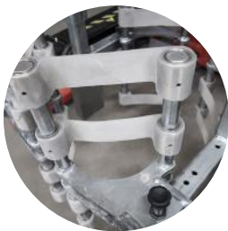
Speciálisan kifejlesztett poliuretán fogóbetétek
