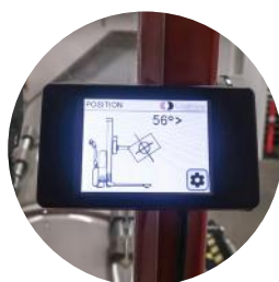
Intuitív kijelző a forgási szögek és a sebesség előbeállításához
